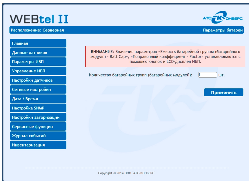
Рисунок 15 - Страница настройки параметров батареи для однофазных ИБП мощностью 6, 10 кВА исполнения R-X
